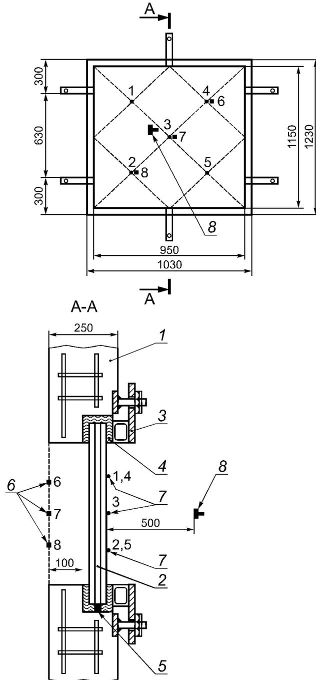
1 - железобетонная стена; 2 - образец для испытаний;
