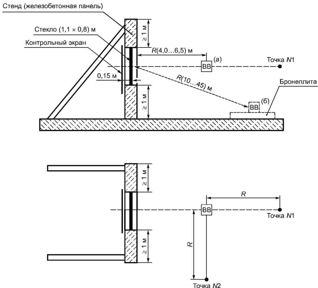
(а) - воздушный взрыв; (б) - наземный взрыв;
